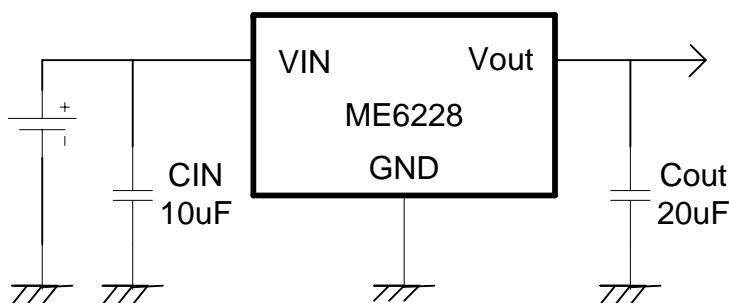
特别注意：当输入电压超过 15V 时，由于使用陶瓷输入电容上电尖峰严重，必须采用电解电容或者钽电容作为输入电容。
